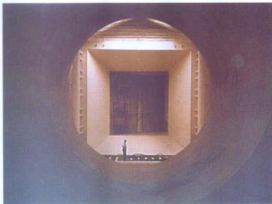
La galleria del vento IWT-Ice Wind Tunnel è la più grande macchina al mondo in grado di generare nuvole
