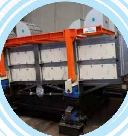
Группа единиц **REMBE® "Q-Box"** расположена в верхней части просеивающей машины вместо традиционных разрывных предохранительных мембран. Их функция: позволять плавный отвод в случае взрыва и подавлять волну давления, возникающую при взрыве. В этом случае пламя и волна давления уменьшаются до некритичных размеров внутри здания и безопасное расстояние, которое должно быть вокруг машины, также уменьшается.
