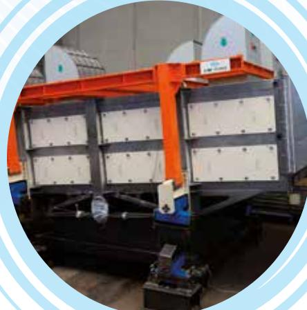
一组REMBO“Q-Box装置”代替传统的防爆板，位于筛分机的上部分。其功能是：在发生爆炸时可以逐渐通风，并减轻爆炸本身产生的压力波。通过这种方式，厂房内的火焰和压力波将减少到非临界效应，并且机器周边应预留的安全距离也将减小。
