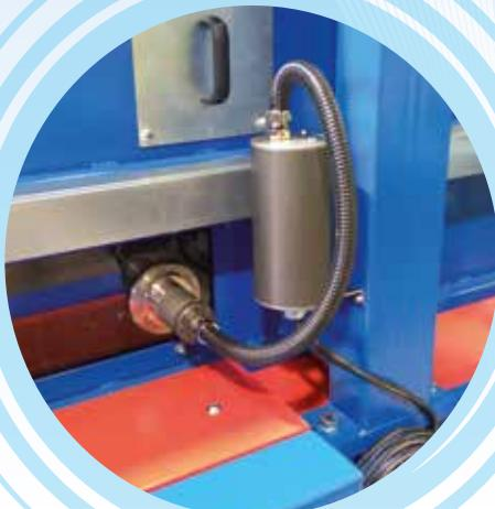
Микроволновый датчик для измерения влажности и плотности - установленный на дозирующем бункере для смесителя - деталь
